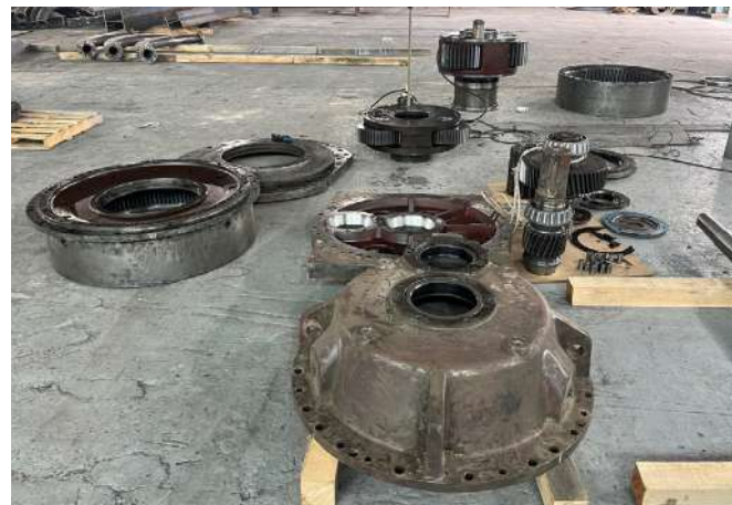
▲ 쌍용시멘트(동해항) 감속기 OVERHOLE
